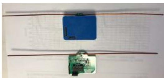
図2:バッテリーレスセンサのプロトタイプ
