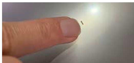
図1：粉末コンピュータと名付けた極小エッジコンピュータの試作品
