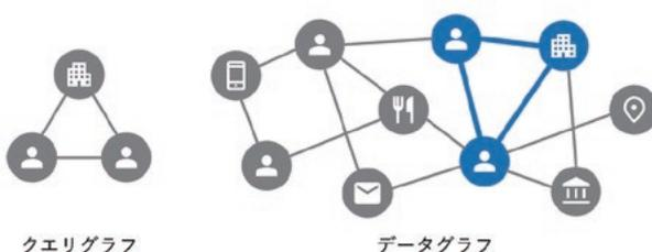
サブグラフマッチングの例。クエリグラフと同じ構造を持つ部分をデータグラフの中から発見する。
