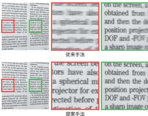
図1：重畳イメージングによる全焦点画像の合成
